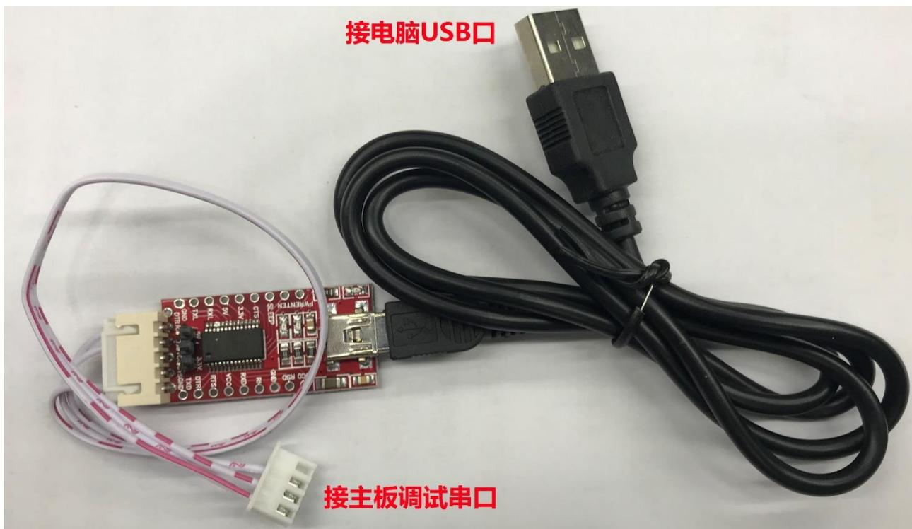
连接串口排线 4Pin 端到主板调试串口 J10。
