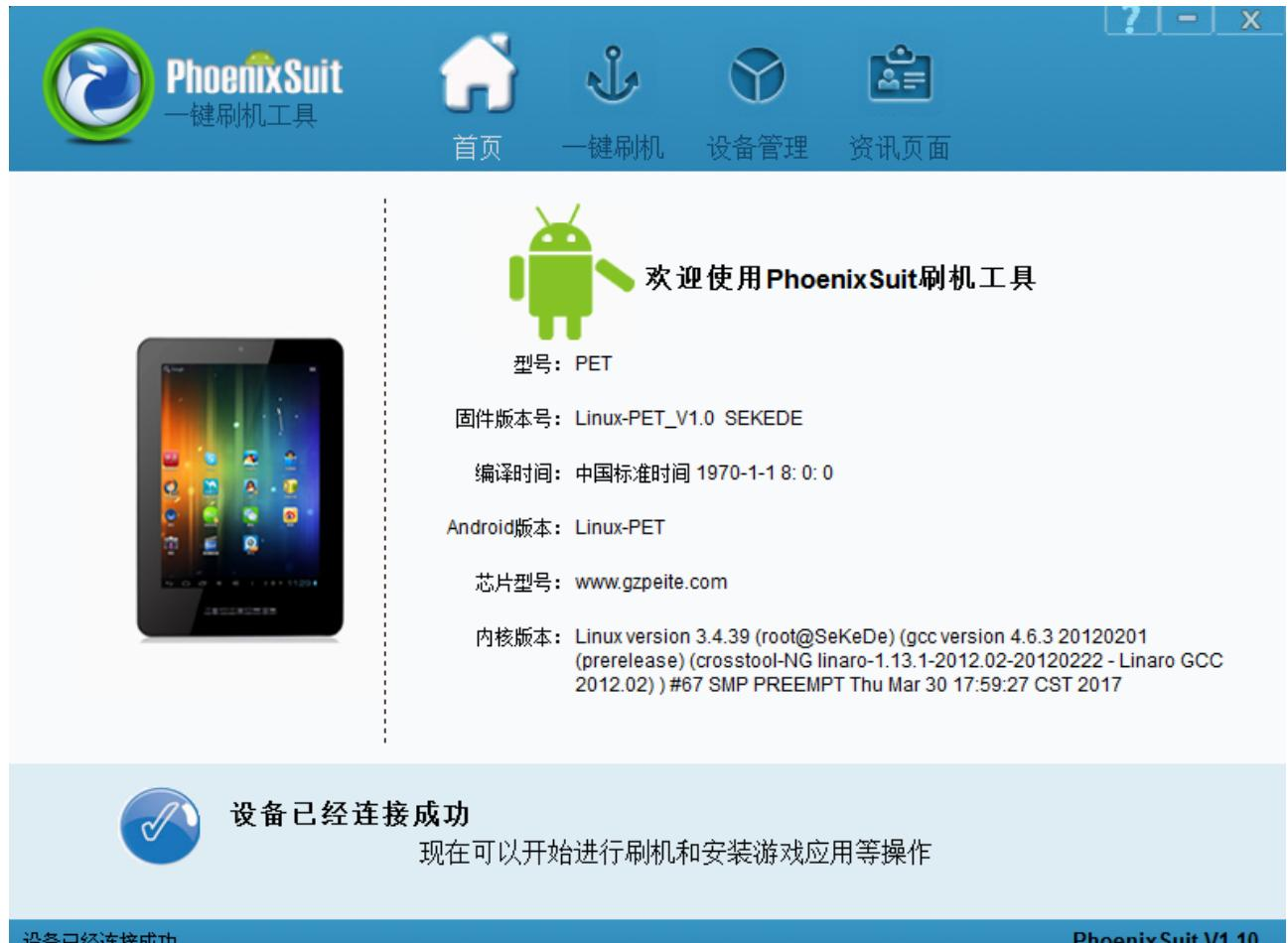
烧写操作需要首先通过 Micro USB 数据线连接主机的开发板，在进行烧写时如果出现主机识别到新的设备没有正常安装驱动的情况时，需要手动安装设备驱动程序，驱动程序位于开发工具文件夹内。
